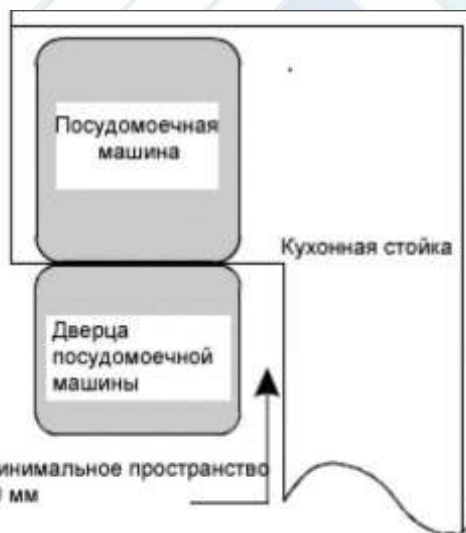
РИСУНОК 2 Минимальное пространство, необходимое для открытия двери.
